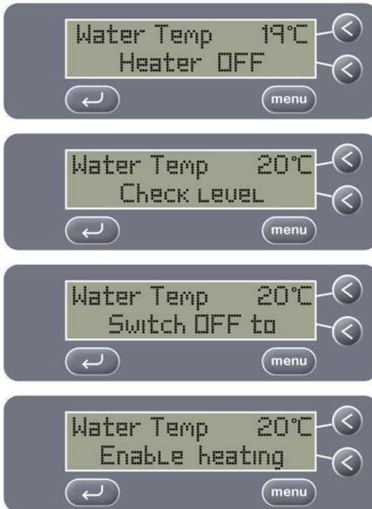
Para continuar utilizando el baño de ultrasonido digital de Grant, rellene con líquido hasta el sensor de líquido, y apague y vuelva a encender la unidad.
