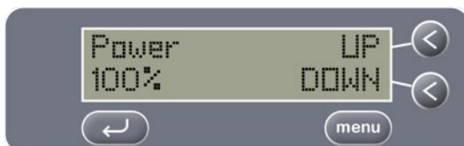
Utilice las teclas ARRIBA y ABAJO para aumentar o disminuir los dígitos entre 50 y 100%. Una vez seleccionado el nivel de potencia correcto, utilice la tecla MENU para pasar a la pantalla siguiente.
