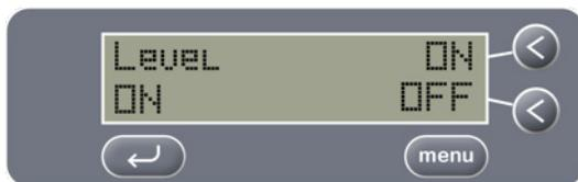
El sensor de nivel es un dispositivo resistivo, por lo que no detecta líquidos con muy poca conductividad, como el agua pura desionizada (DI). El sensor de nivel puede desactivarse para aplicaciones de limpieza especiales en las que se utiliza agua desionizada. Utilice las teclas ACTIVAR y DESACTIVAR para configurar la función de sensor de nivel de líquido. Una vez seleccionada la opción que desee, utilice la tecla MENU para pasar a la pantalla siguiente.
