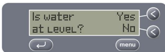
Cuando se desactiva el sensor de nivel, la temperatura del líquido establecida se reduce automáticamente a 5°C (40°F). La temperatura establecida se puede aumentar en el sistema de MENÚ (consulte la página 9).
