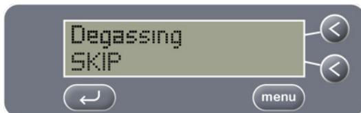
El proceso de desgasificación consiste en eliminar todas las burbujas del agua ya que estas impiden que se pueda efectuar la limpieza. Una vez que todas las burbujas han llegado a la superficie, complete el ciclo de desgasificación al pulsar la tecla ↶.
