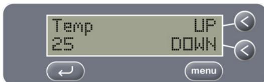
Utilice las teclas ARRIBA y ABAJO para ajustar con precisión la temperatura del líquido de limpieza entre ambiente y 70°C (160°F)
