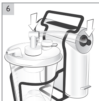
6 Sprawdzić solidność mocowania wszystkich złączy rurki podciśnieniowej.
